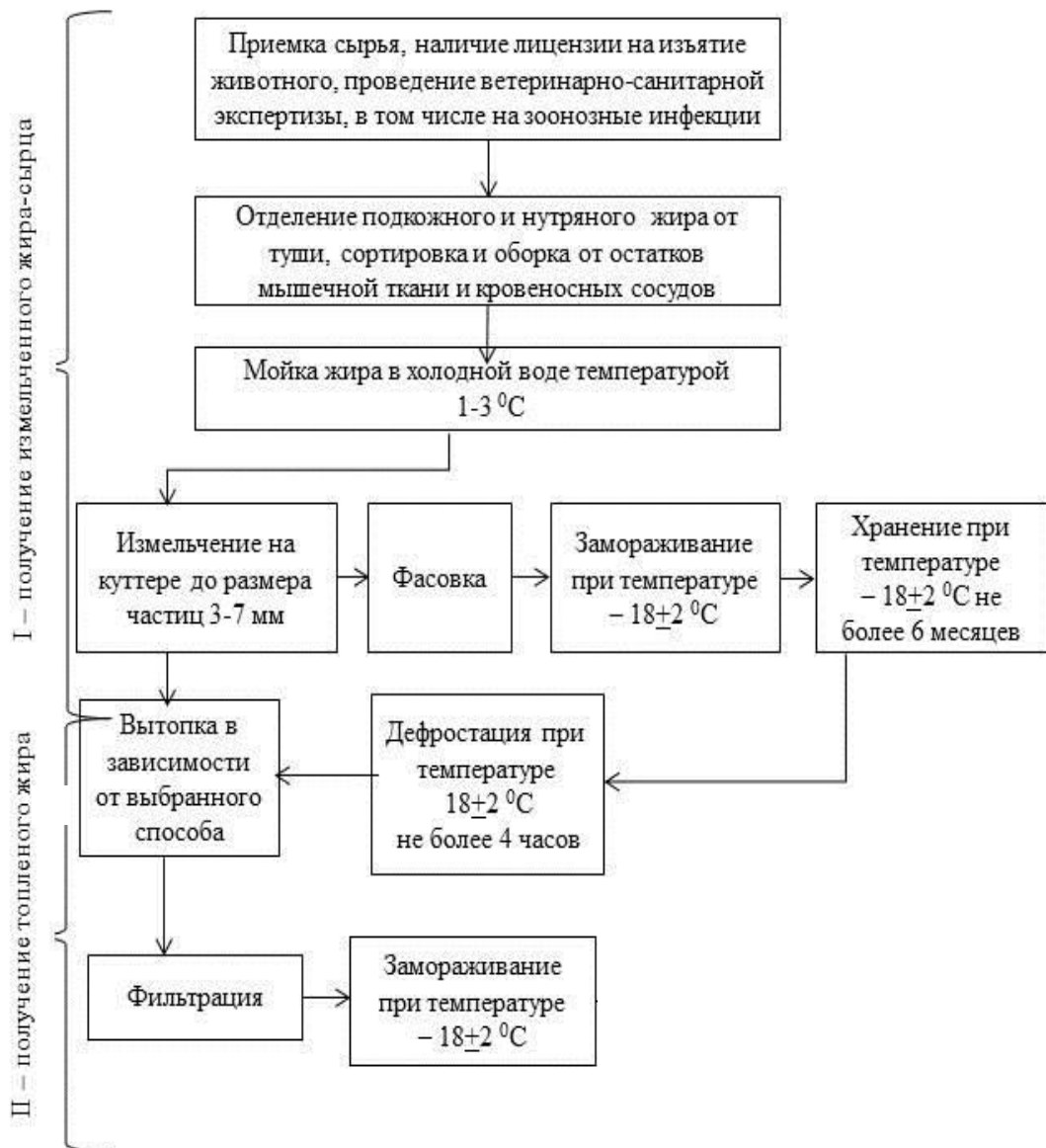
Рисунок 5.3.1 – Схема заготовки и первичной переработки животных жиров
