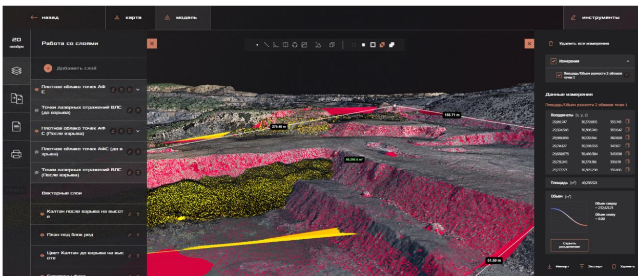
Рисунок 58 – Измерение объема разности двух облаков точек
